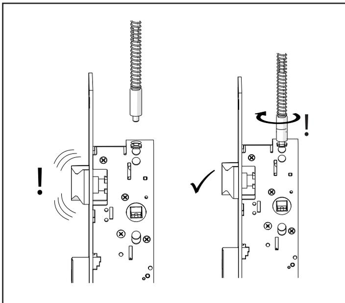
Erst nach der Stangenmontage steht die Falle unter Federspannung.
